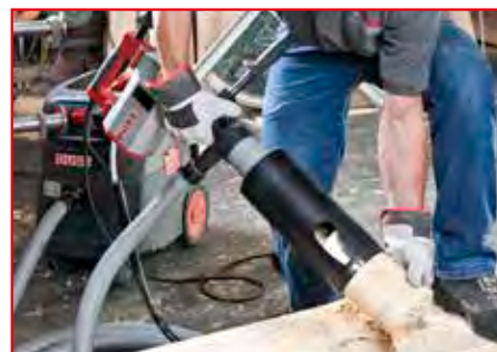
Bohren in Holz mit Staubabsaugung – handgeführt
