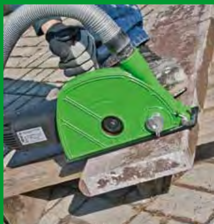
Trennen von Betonborde
