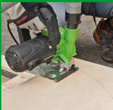
Kurvenschnitt mit Diamantkurvenscheibe
