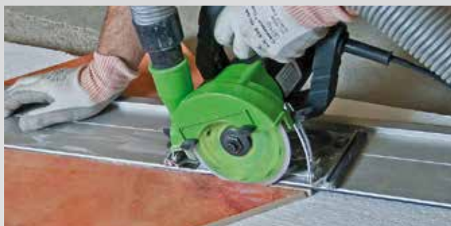
Maschine auf Führungsschiene (Anschlag für präzise Schnitte)
