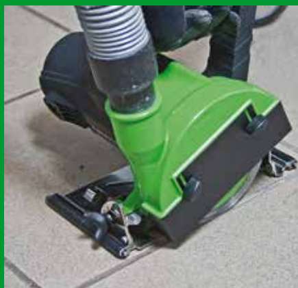
Fliesen- und Fugensanierung – Trockenschnitt mit Eintauchfunktion und Schnitttiefenbegrenzung
