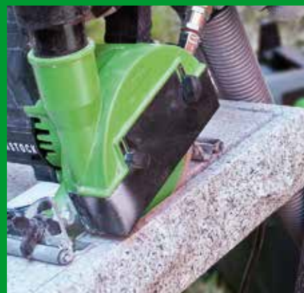
Tropffuge mit Frässcheibe – Eintauchfunktion und Schnitttiefenbegrenzung
