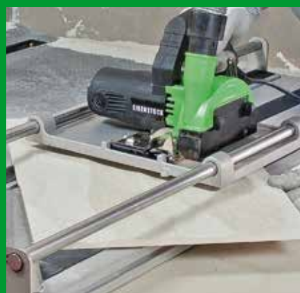
Diagonalschnitt mit Trenntisch
